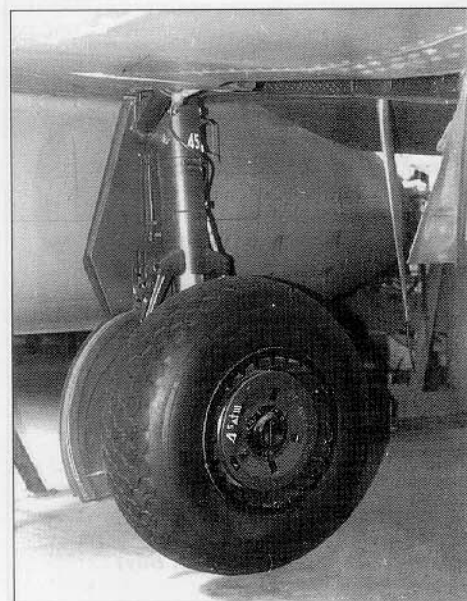
Pravá hlavní podvozková noha a kolo, v pozadí anténa soupravy FuG 16ZY. • Starboard main undercarriage leg and wheel, with FuG 16ZY antenna in the background. (Photo M. Bílý)
