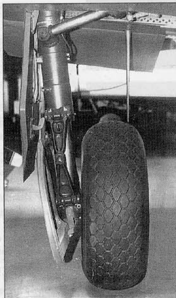
Pravá hlavní podvozková noha a kolo, v pozadí anténa soupravy FuG 16ZY. • Starboard main undercarriage leg and wheel, with FuG 16ZY antenna in the background. (Photo M. Bílý)
