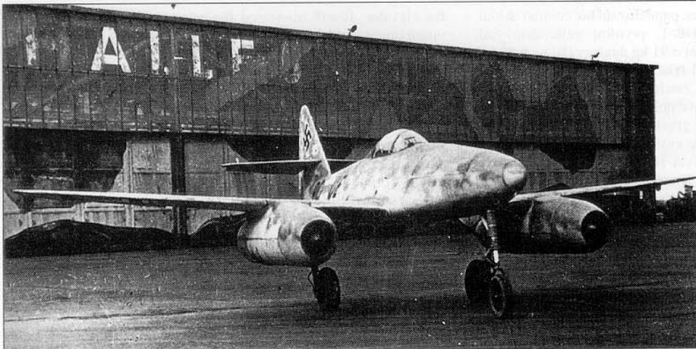
Me 262 V5, na němž byl poprvé instalován (pevný) podvozek příďového typu. Na vstupních otvorech motorů jsou připevněny ochranné sítky. (sbírka E. Creek via J. Zazvonil)
