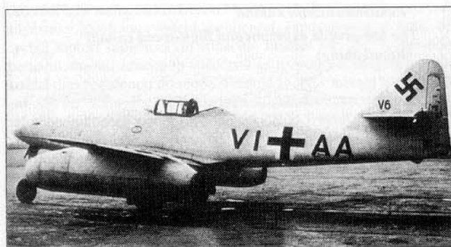
Prototyp Me 262 V6 měl již podvozek zatahovací, nastříkán byl na všech plochách barvou RLM 76. (sbírka M. Balouse) The Me 262 V6 prototype already had the undercarriage retractable. The aircraft was sprayed RLM 76 overall.
