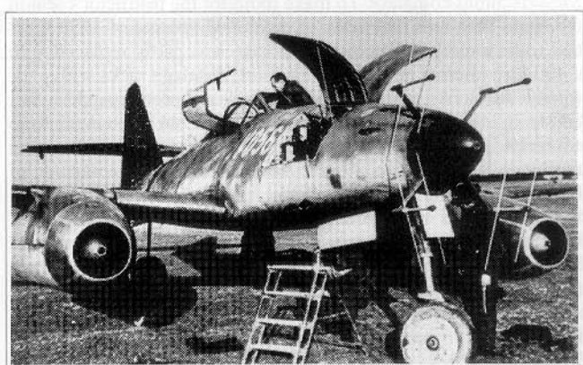
Mechanici při práci na prvním "radarovém" Me 262A (výr.č.170 056), vybaveném zařízením FuG 218 Neptun VI, leden 1945. (sbírka E. Creek via J. Zazvonil) Technicians working away on the first radar-equipped Me 262A (W.Nr. 170 056), fitted with the FuG 218 Neptun VI. January 1945.
